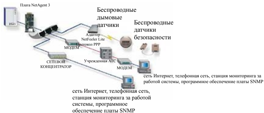
Стандартная топология сетевого управления ИБП.
