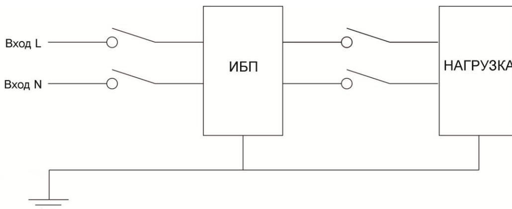
Рис. 2-1 Подключение кабелей
