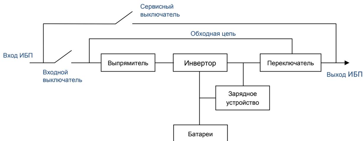
Рис.1-1 Блок-схема ИБП
