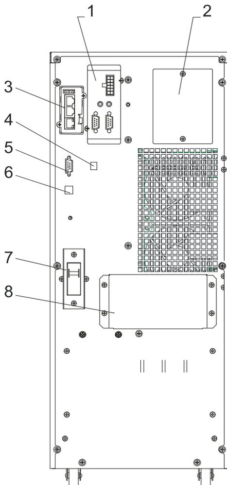
1. Плата параллельной работы
