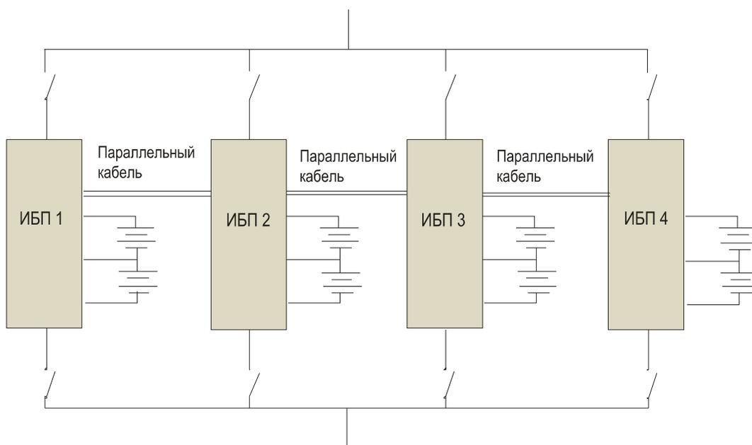
Рис.2-3 Параллельная система
