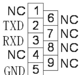
Соединение между портом компьютера RS232 и портом ИБП RS232
